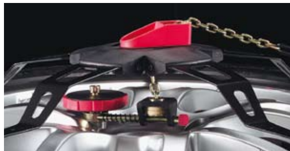
Il dispositivo speciale di blocco della catenella realizzato in nylon rinforzato con fibra di vetro consente la regolazione ottimale dell'ancoraggio e fornisce la migliore spinta elastica alle braccia. Brevetto nr. EP 0226131
